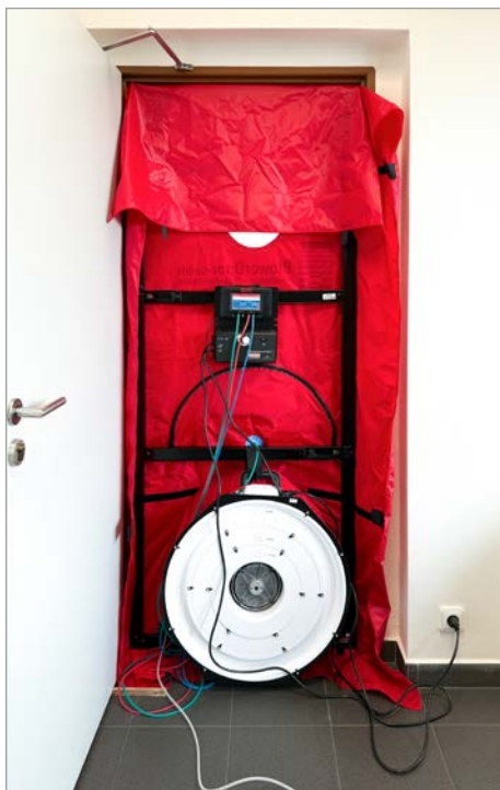
Pro ověření těsnosti budovy provádíme zkoušky pomocí profesionální měřicí sestavy Blowerdoor test
