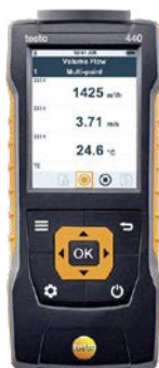
K přesnému měření průtoku vzduchu, rychlosti proudění a objemového průtoku využíváme profesionální anemometr TESTO 440
