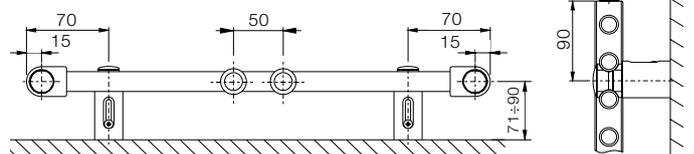
Der gelieferte Satz für die Befestigung des Heizkörpers an der Wand beinhaltet vier Stück Spezialkonsolen aus Kunststoff, Schaftschrauben, Dübel und eine Montageanleitung.
