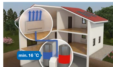
LÉTO tepelné čerpadlo (bez vzniku kondenzátu)
